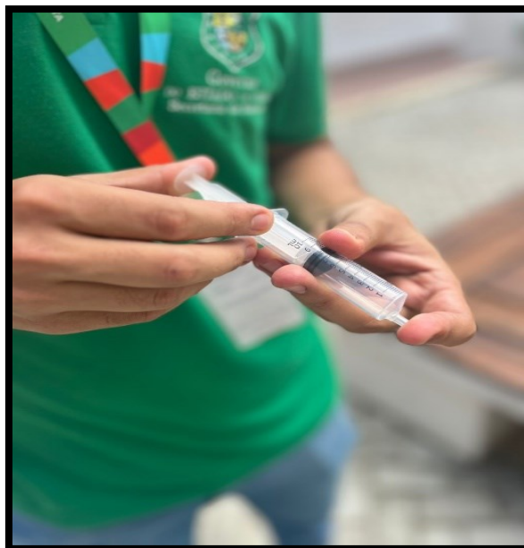
Figura 03: Compressão do ar dentro da seringa com a extremidade vedada
