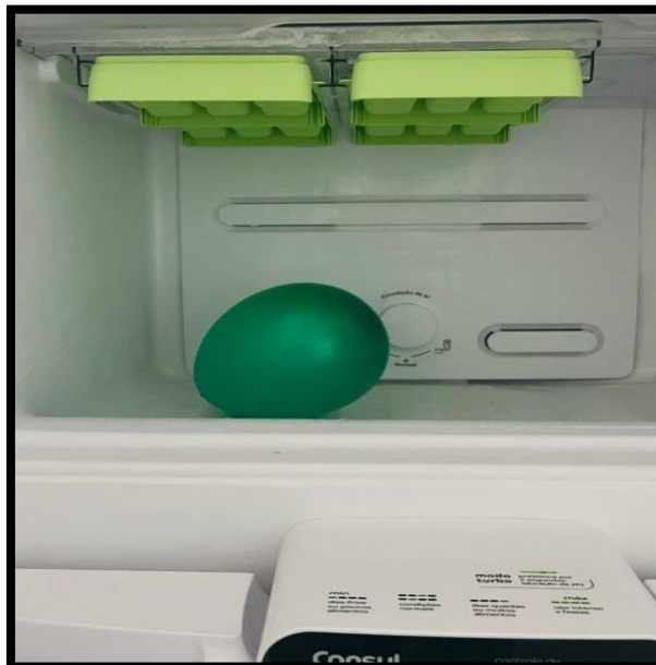
Figura 04: Balão colocado no congelador para resfriamento do gás interno
