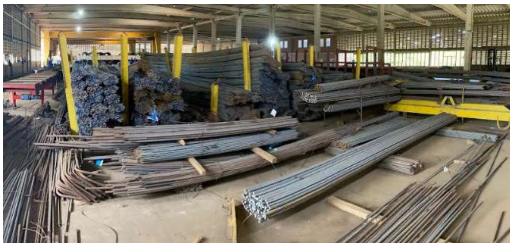
Figura 13 – Estoque de vergalhões de aço
