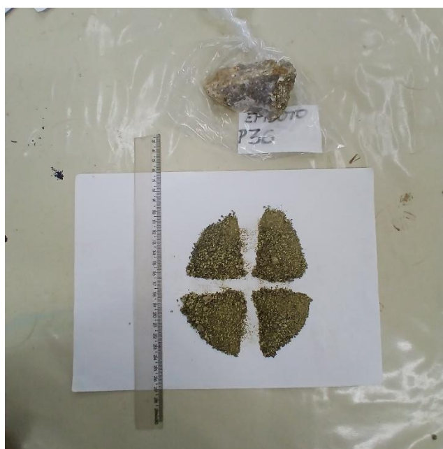
Fotografia 1 – Processo de quarteamento das amostras.
