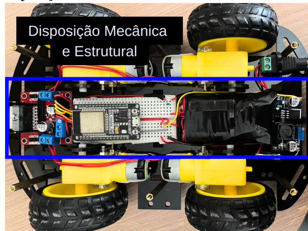
Figura 13 – Disposição Mecânica e Estrutural no Chassi
