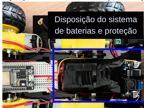
Figura 14 – Disposição do Sistema de Alimentação e Proteção
