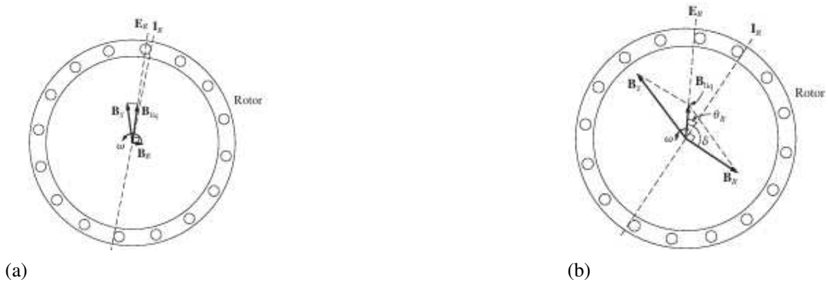
Figura 5 – A produção de conjugado induzido em um motor de indução. (a) Campo Magnético com carga leve; (b) Campo Magnético com carga pesada.
