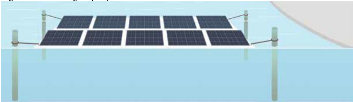
Figura 14 – Ancoragem por pilares ou estacas
