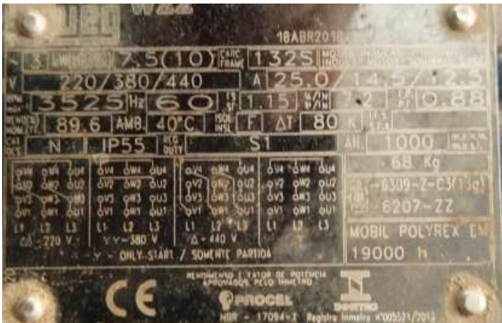
Figura 6: Dados de placa dos motores de recalque
