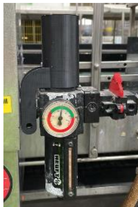
Figura 14 – Trava da regulagem do expulsador de garrafas
