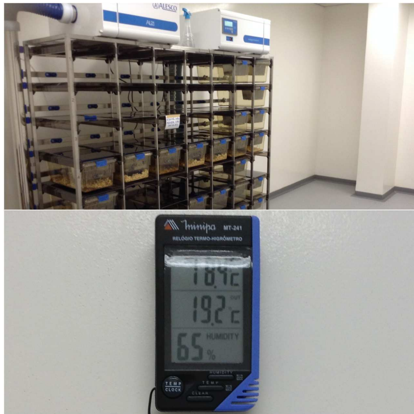
Figura 7. Rack ventilado com microisoladores e relógio termo-higrômetro.
