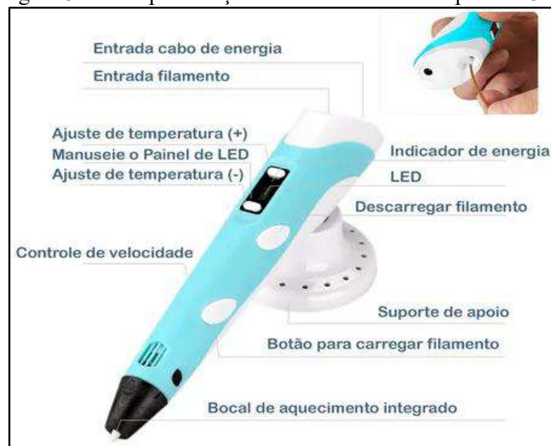
Figura 3 - Principais funções de uma caneta de impressão 3D
