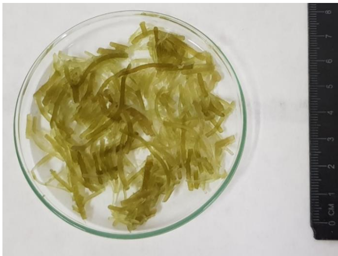
Figura 7: Aspecto visual do Rp após tratamento alcalino.
