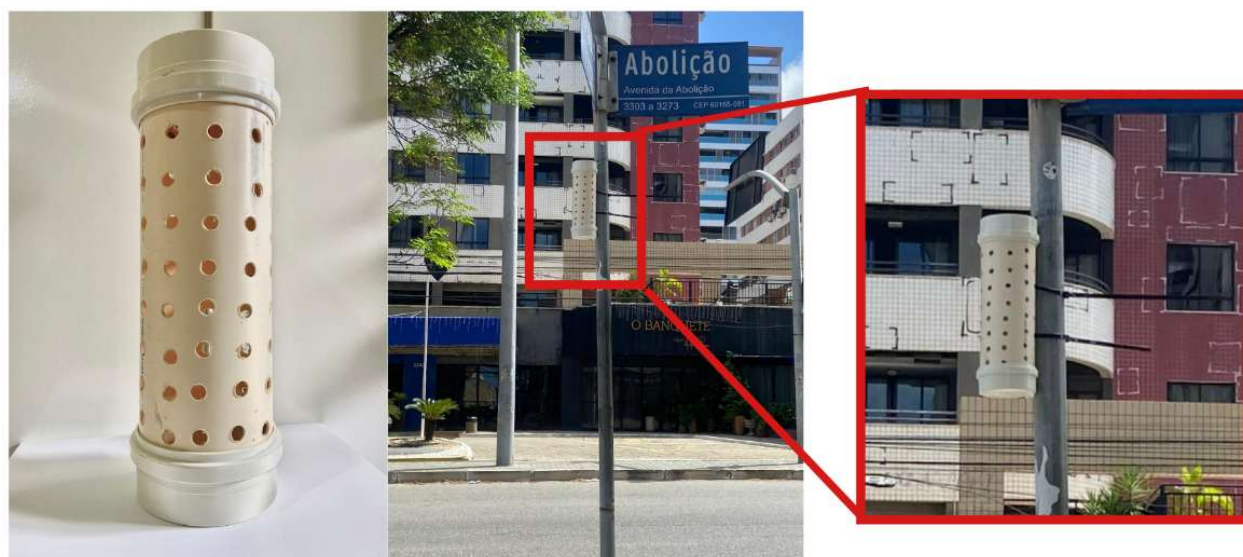
Figura 8. Ilustração do abrigo do sensor termo-higrômetro. Fonte: Elaborado pela autora
