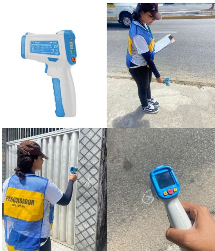
Figura 10. Instrumento e aplicação do método de medição de temperaturas superficiais em campo. Fonte: Elaborado pela autora
