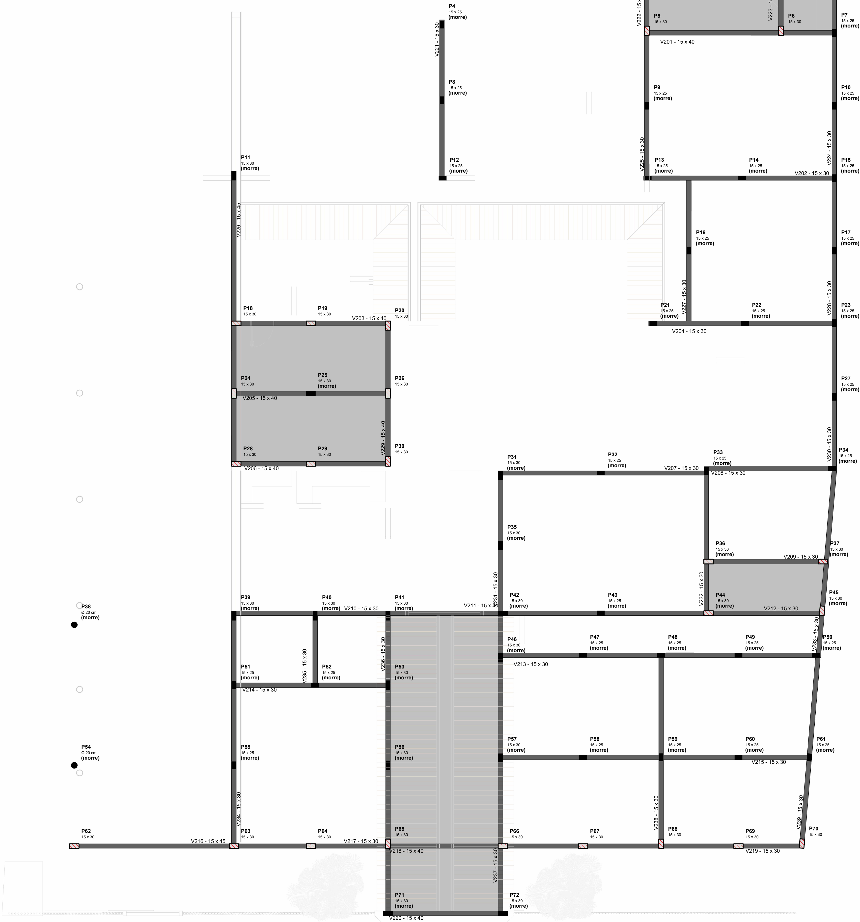
1 Planta de fôrma - Cobertura 1 : 60
