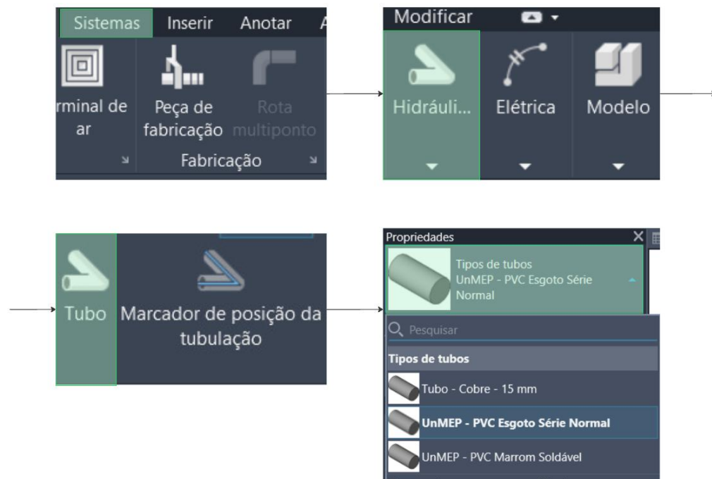
Figura 14- Processo para inserir tubulações no Revit® 2024
