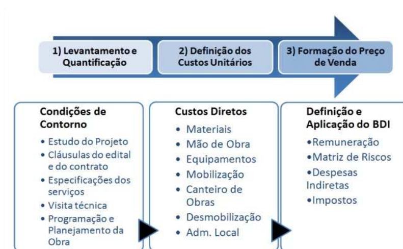
Figura 2- Sequência para Elaboração de Orçamentos de Obras.
