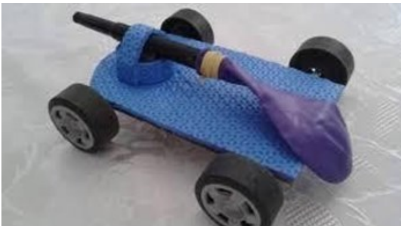
Figura 9 – Carrinho movido a ação e reação
