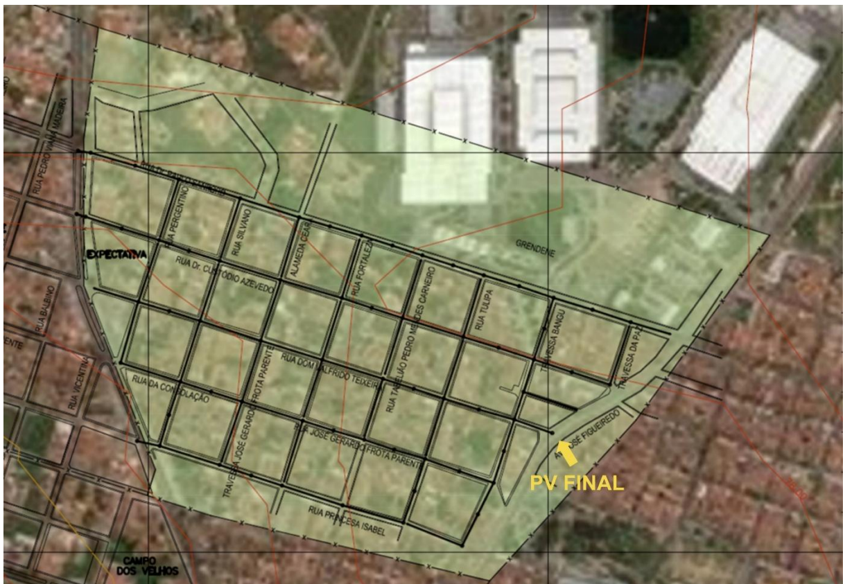
Figura 41 – Rede coletora de esgoto para o bairro Alto da Expectativa.
