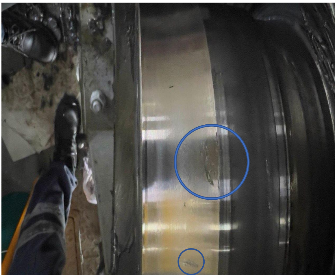
Figura 21 - Parte do tambor com destaque acentuado de material
