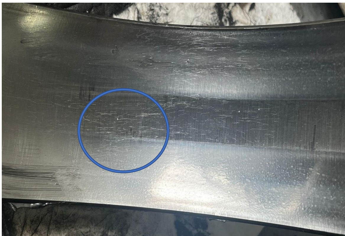
Figura 20 - Superfície com desgaste por abrasão
