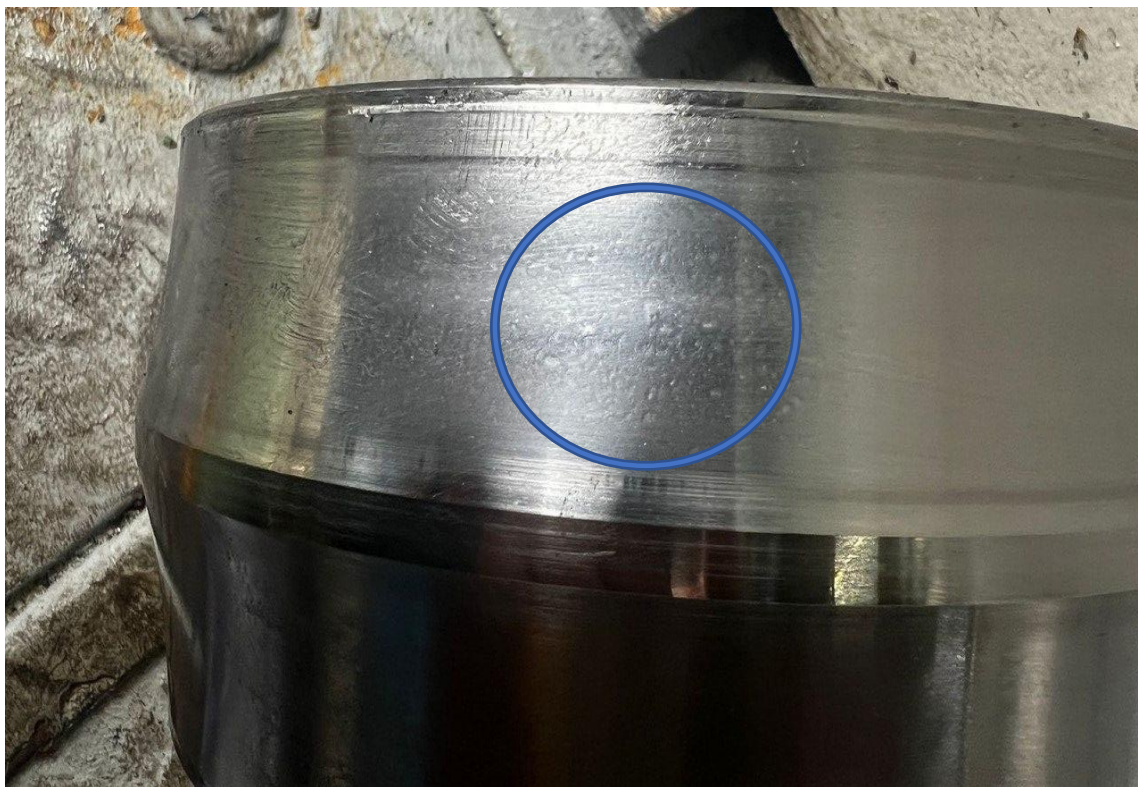
Figura 19 - Riscos concentrados na faixa de carga
