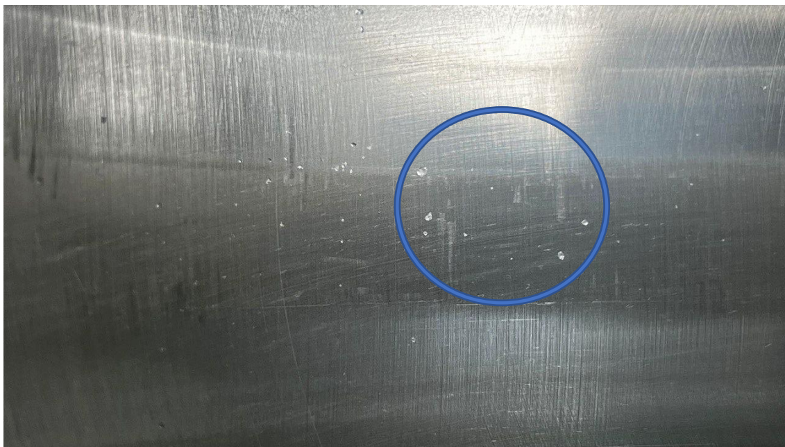
Figura 18: Pitting e micropitting na região de contato
