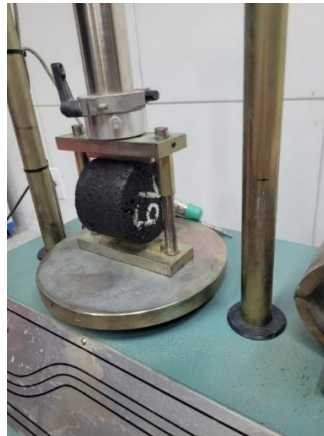
Figura 4 - Ensaio de Resistência à Tração na Prensa Marshall 30kN
