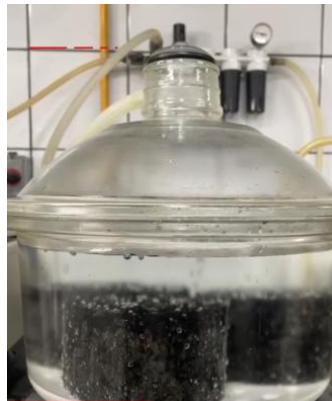
Figura 6 - Corpo de prova condicionado no ensaio de DUI
