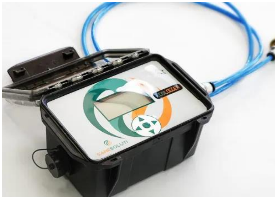
Figura 17 – Modelo de Datalogger utilizado na aferição da pressão.
