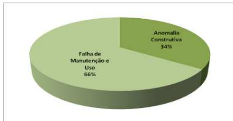
Figura 3 – Distribuição da incidência dos acidentes prediais por tipo de origem.
