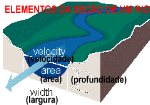
Figura 4 - Elementos da seção transversal de um rio.
