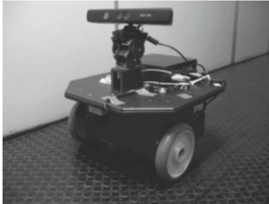
Figura 12 – Sensor Kinect: Câmera do tipo RGB-D.
