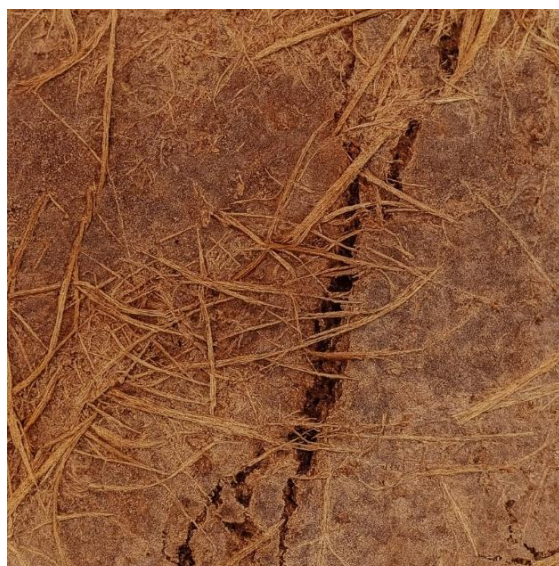
Figura 23 - Fissura no corpo de prova do ensaio de RCS
