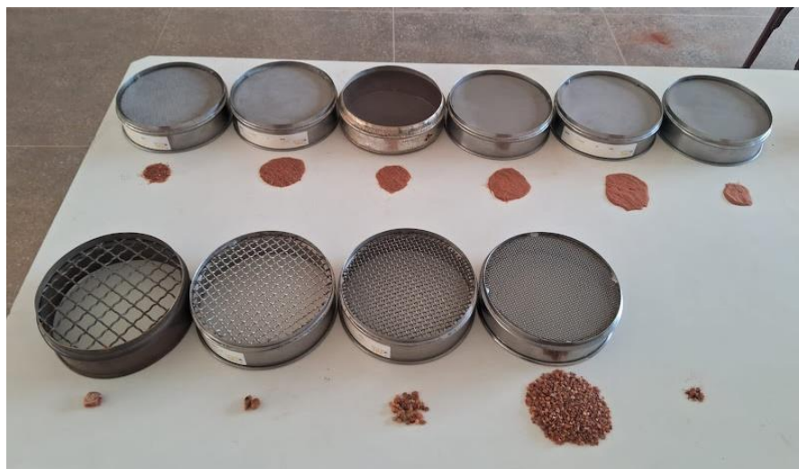
Figura 11 - Ensaio de análise granulométrica por peneiramento
