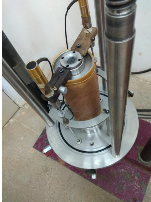
Figura 21 - Ensaio do Módulo de Resiliência
