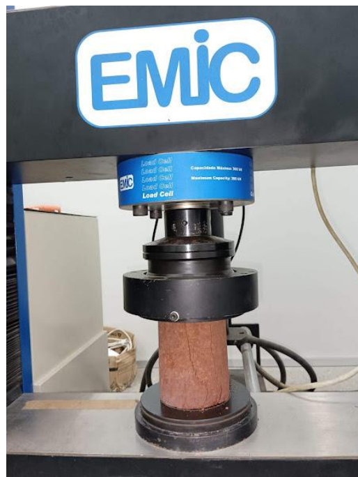
Figura 18 - Ensaio de Resistência à Compressão Simples
