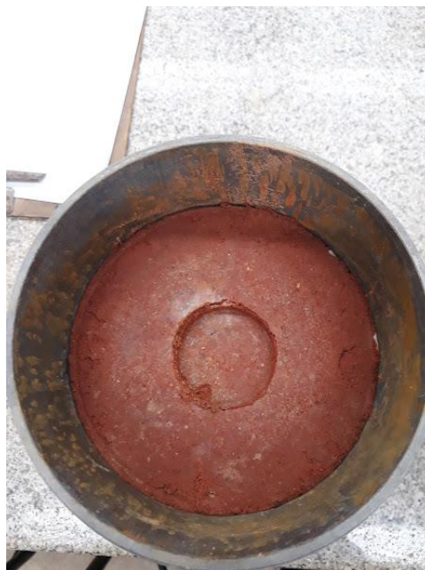
Figura 20 - Corpo de prova do CBR pós ensaio
