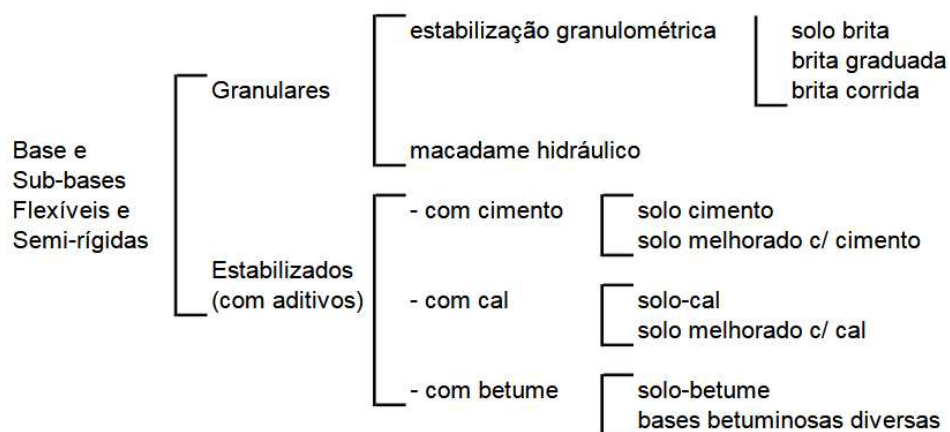
Figura 2 – Classificação de bases e sub-bases Flexíveis e Semirrígidas
