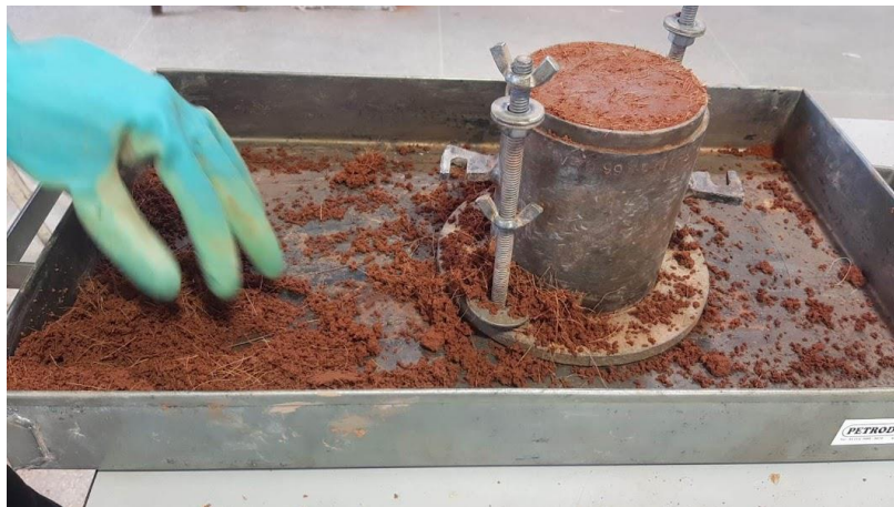
Figura 17 – Moldagem do ensaio de compactação do solo-fibra
