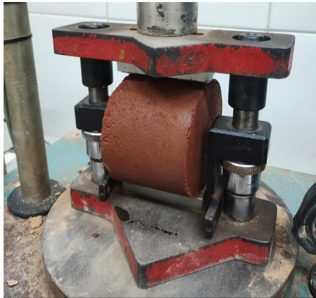
Figura 19 - Ensaio de Resistência à Compressão Por Tração Diametral
