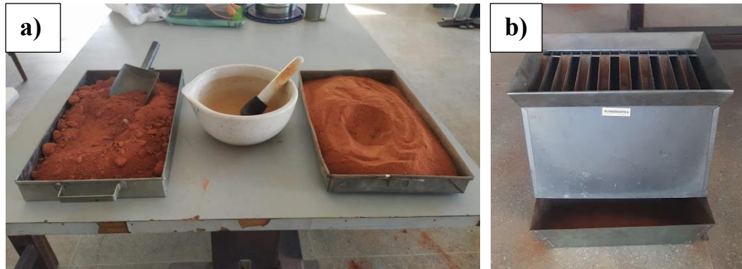
Figura 10 – Preparação do solo: a) Solo destorreado; b) Repetidor de amostra
