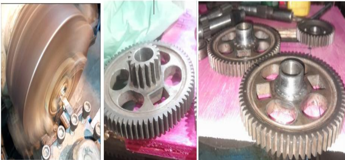
Figura 50: Processo de usinagem de preparação das duas engrenagens de 67 dentes.
