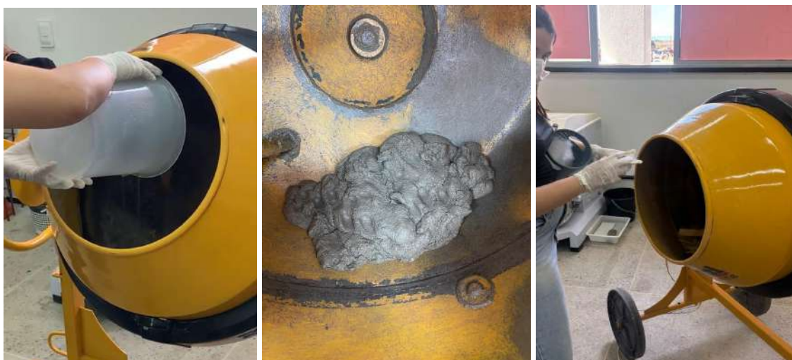
Figura 2 - Produção de argamassa álcali-ativada em laboratório
