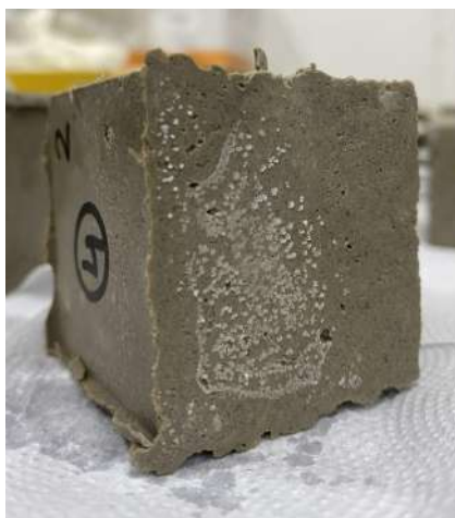
Figura 8 - Surgimento de sais na superfície de amostra da mistura 4 após imersão
