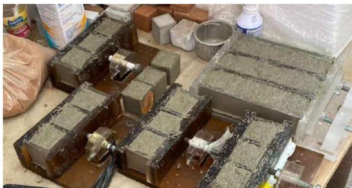
Figura 3 – Argamassa álcali-ativada moldada em fôrmas acrílicas.
