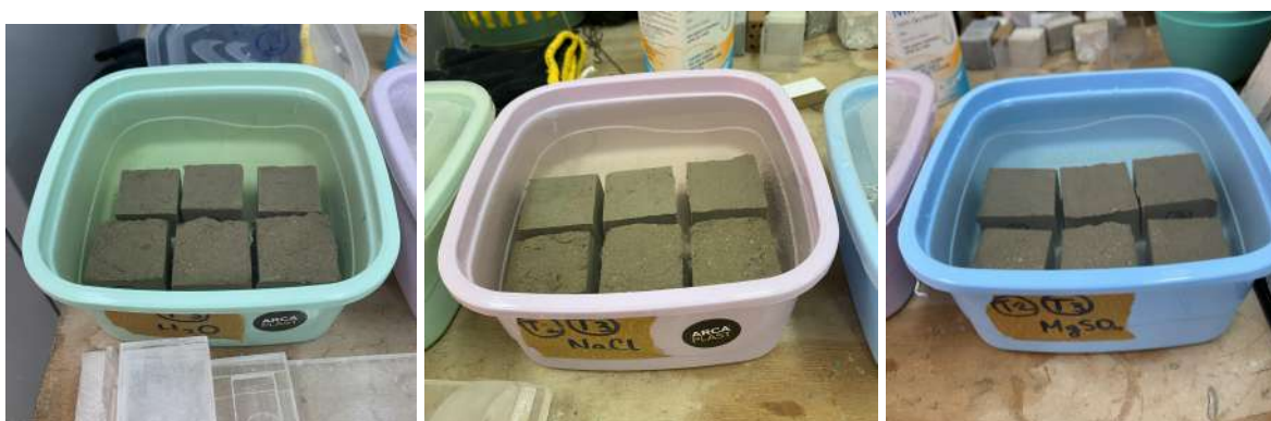
Figura 6 - Recipientes contendo soluções de H 2 O, NaCl e MgSO 4 , respectivamente com CPs imersos
