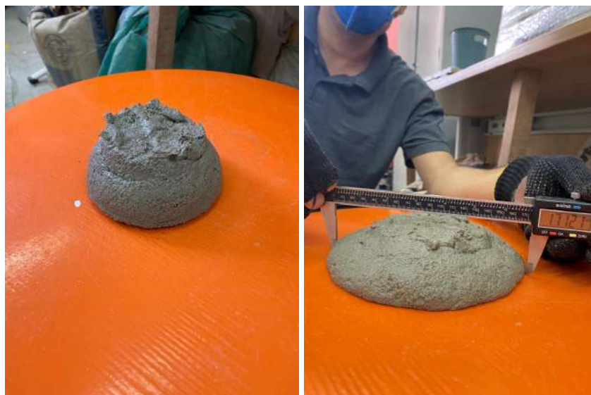
Figura 7- Consistência da argamassa antes e após aplicação de golpes na mesa de consistência, respectivamente
