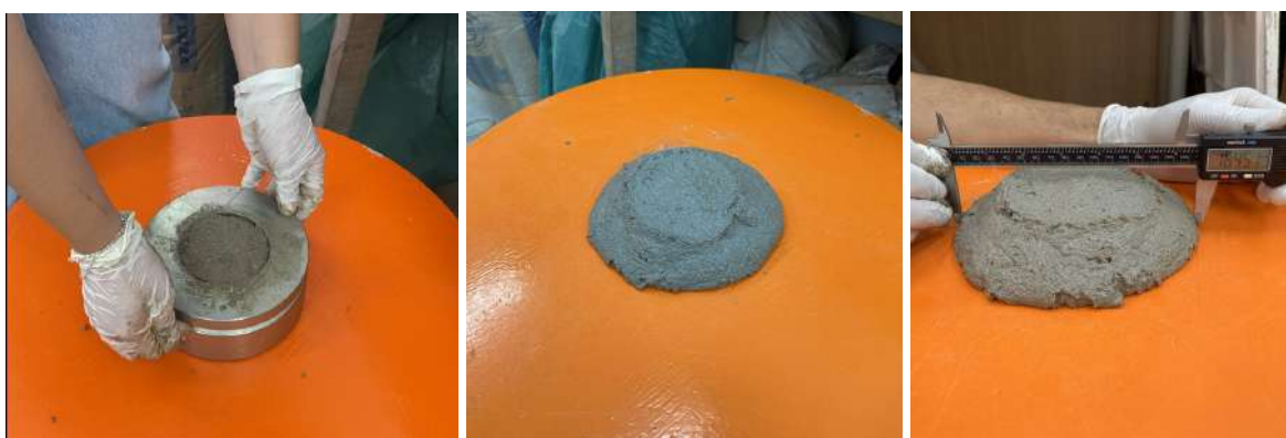
Figura 4 - Ensaio de determinação do índice de consistência
