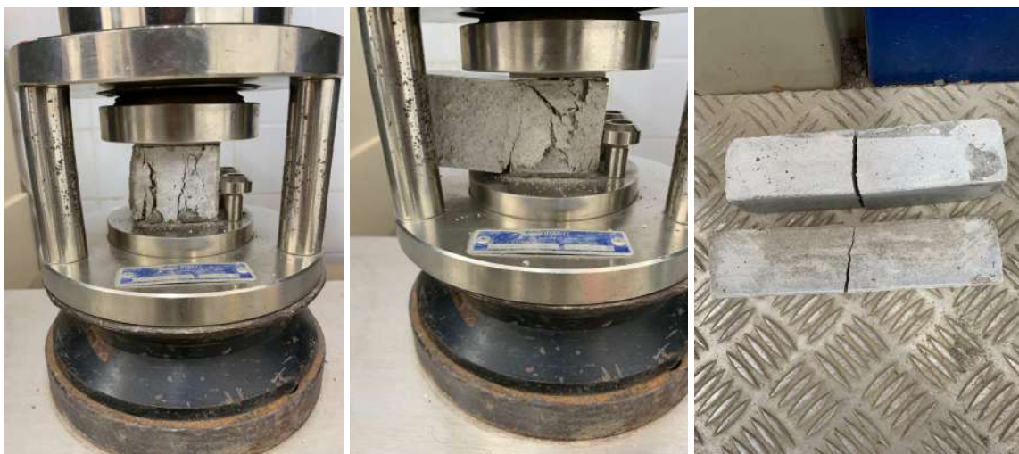
Figura 5 - Realização do ensaio de resistência à compressão e corpos de prova rompidos à tração na flexão
