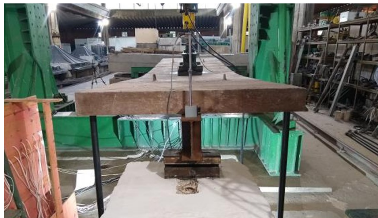
Figura 61 – Deslocamento vertical na viga mista experimental de Lima 2021
