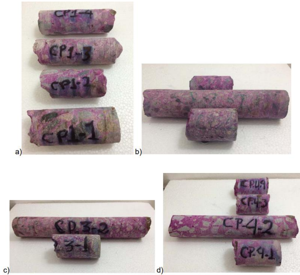
Figura 26: Testemunhos após o ensaio de carbonatação.
