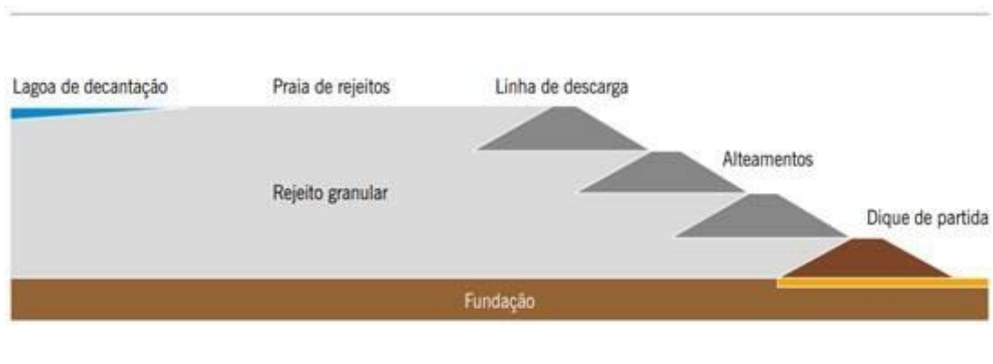
Figura 4 - Alteamento a montante
