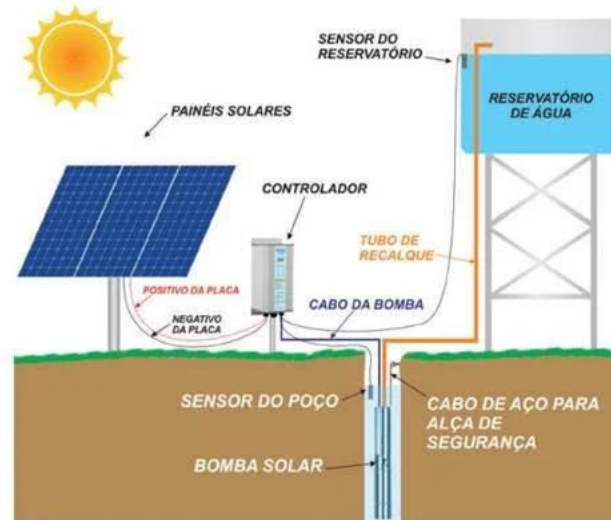
Figura 5 - Bombeamento de água com energia solar
