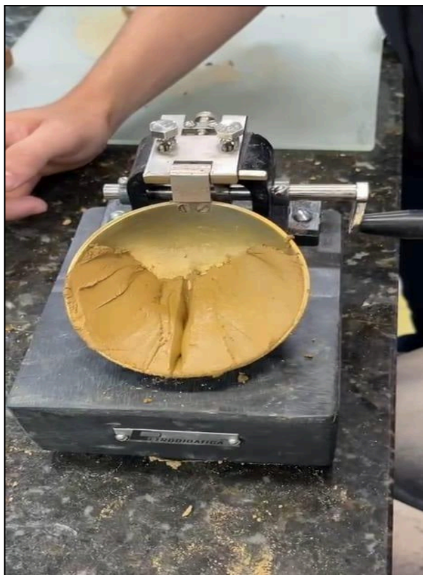
Figura 9 - Ranhura Fechada do ensaio do Limite de Liquidez
