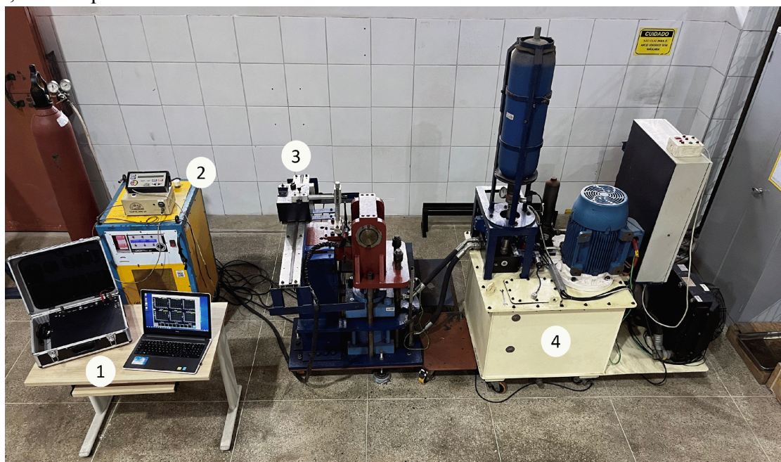
Figura 26 – Bancada de ensaio Trans-Varestraint: 1 – Sistema de aquisição de dados; 2 – Fonte de soldagem multiprocesso; 3 – Tartilope e tocha de soldagem TIG; 4 – Máquina de ensaio Trans-Varestraint.
