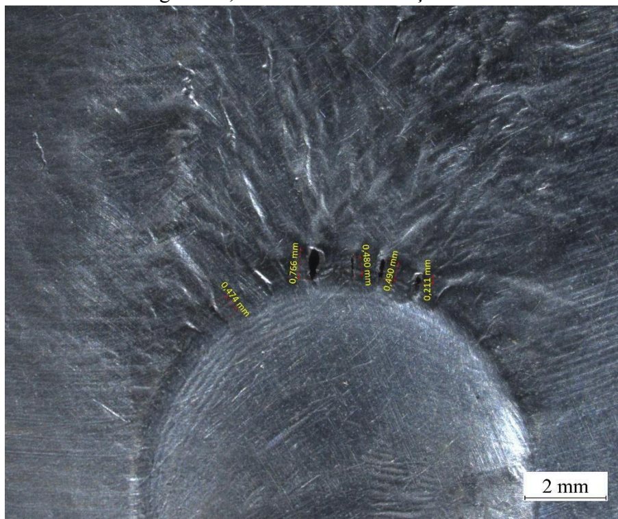
Figura 69 – Macroscopia das trincas de solidificação formadas na liga ERcNi 70/30, soldado com uma energia de 1,09 kJ/mm e deformação de 6%.
