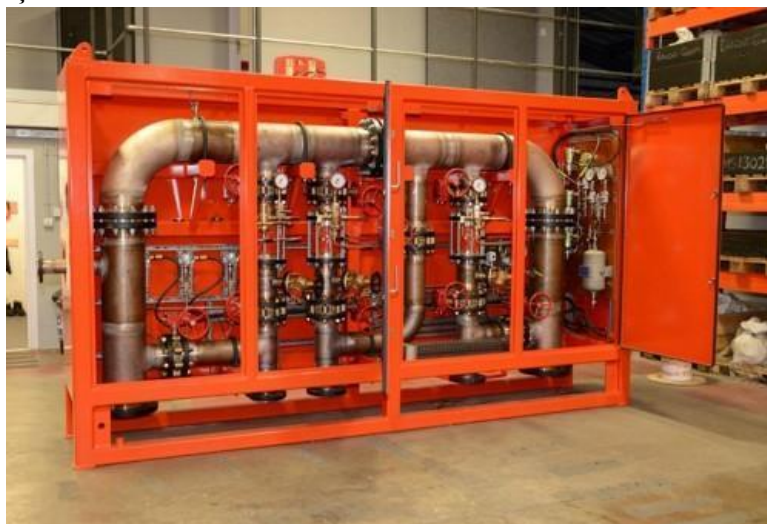
Figura 5 – Tubulações de CuNi 90/10 em um sistema de dilúvio contra incêndio.
