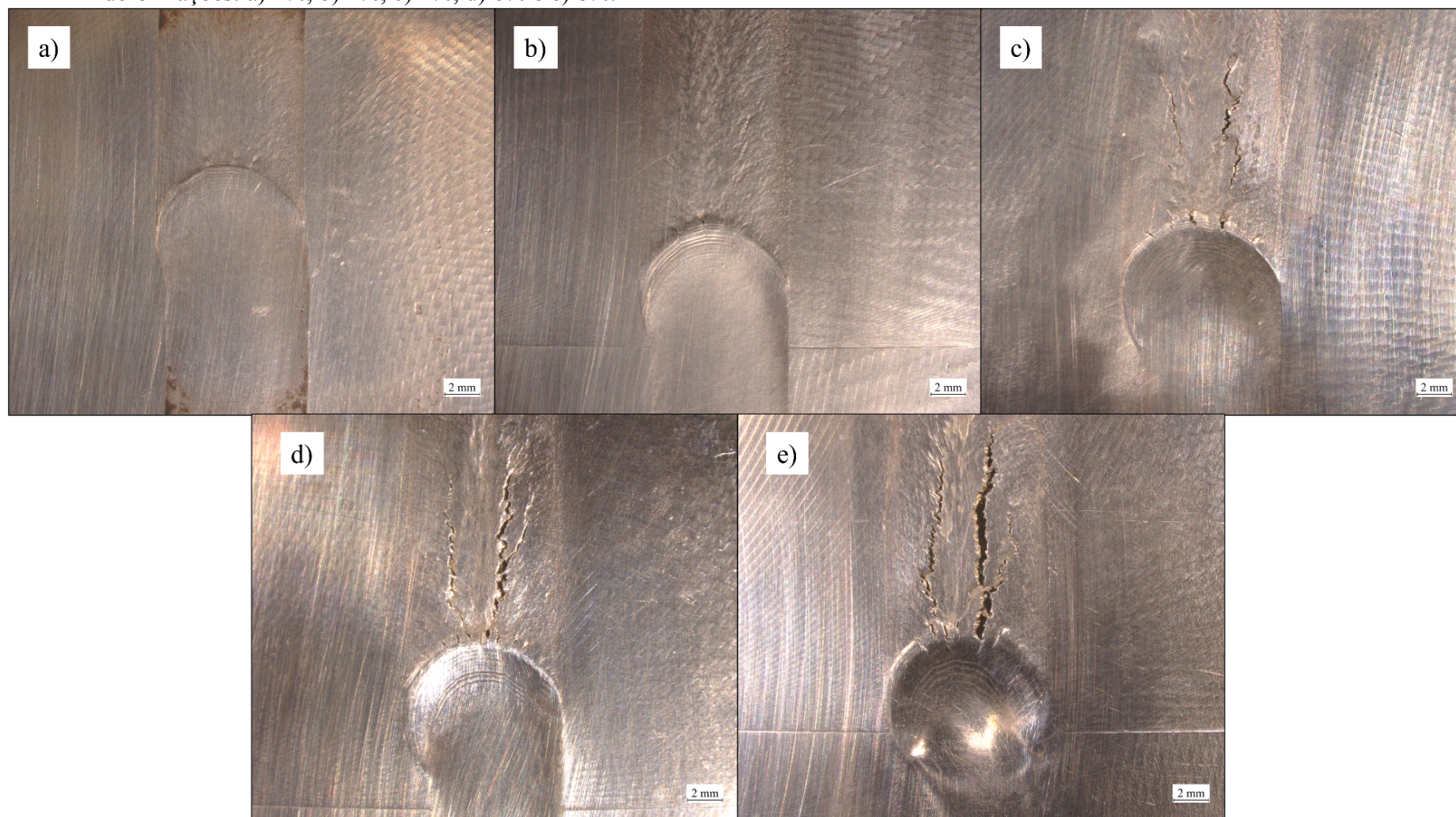
Figura 44 – Trincas formadas no ensaio Trans-Varenstraint da liga CuNi 90/10 soldada com energia de 1,09 kJ/mm, nas deformações: a) 1%, b) 2%, c) 4%, d) 6% e e) 8%.
