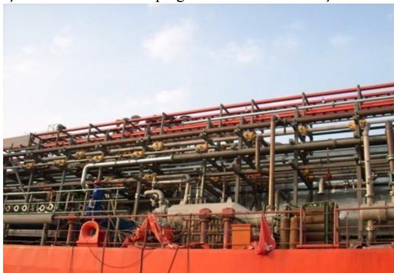
Figura 4 – Tubulação de CuNi 90/10 empregada em uma embarcação comercial
