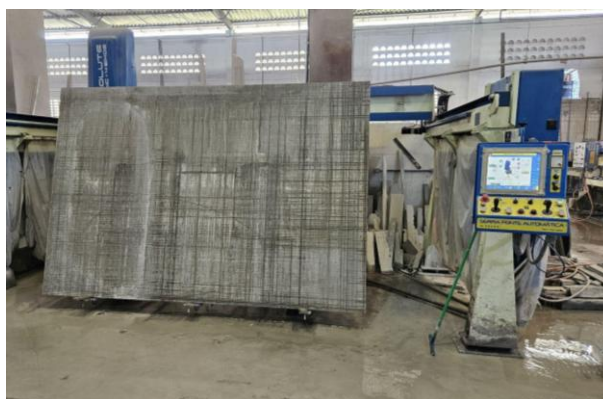
Figura 10 – Serra ponte automática – Aço Ar (CNC)
