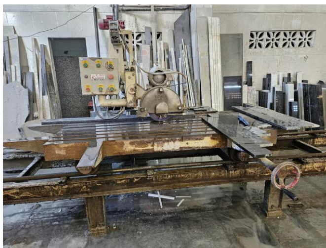
Figura 12 – Serra de corte manual – RDS Samec
