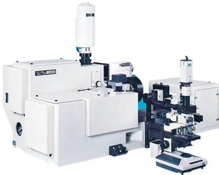
Figura 9 – Espectrômetro T64000, usado para a obtenção dos espectros no intervalo de 15 a 3200\text{ cm}^{-1} .
