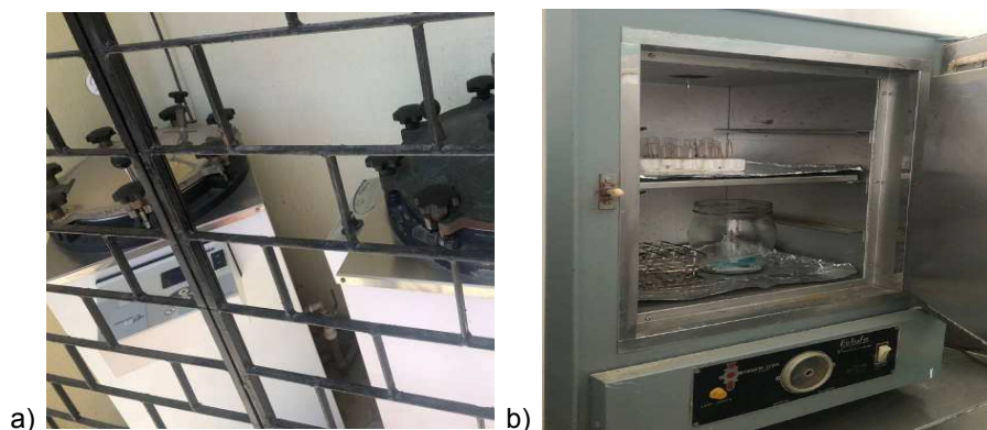
Figura 13: a) Autoclave protegido com grades, cadeados e cobertura; b) Estufa de secagem.
