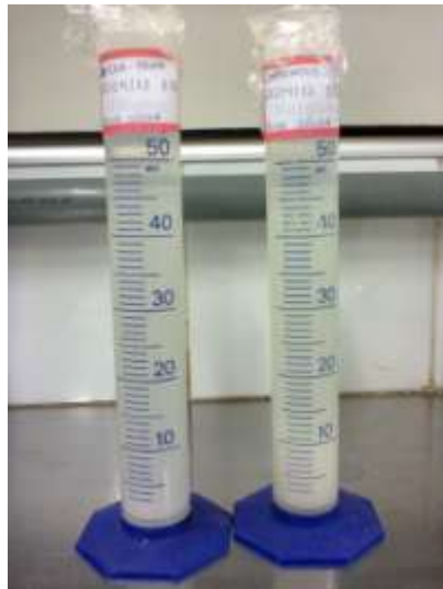
Figura 8 – Provetas contendo as suspensões de hidroclorotiazida para o teste de Velocidade de Sedimentação.
