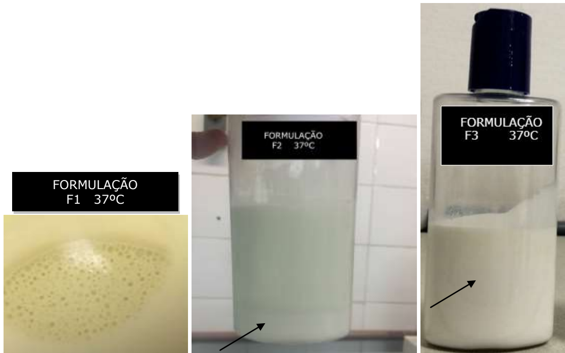
Figura 5 – Imagens das formulações F1, F2 e F3 mantidas em estudo de estabilidade acondicionadas a 37°C durante 15 dias.
