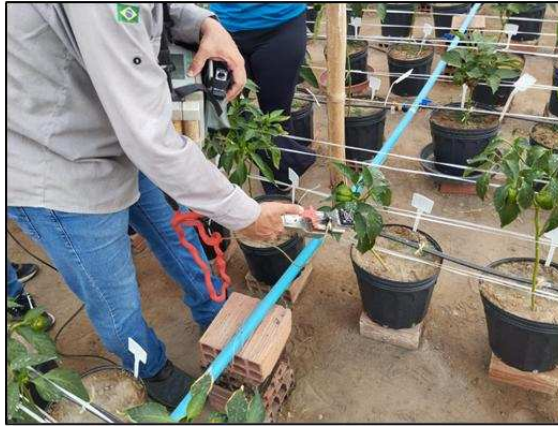
Figura 12. Análise das trocas gasosas com um analisador portátil de gases no infravermelho (IRGA).
