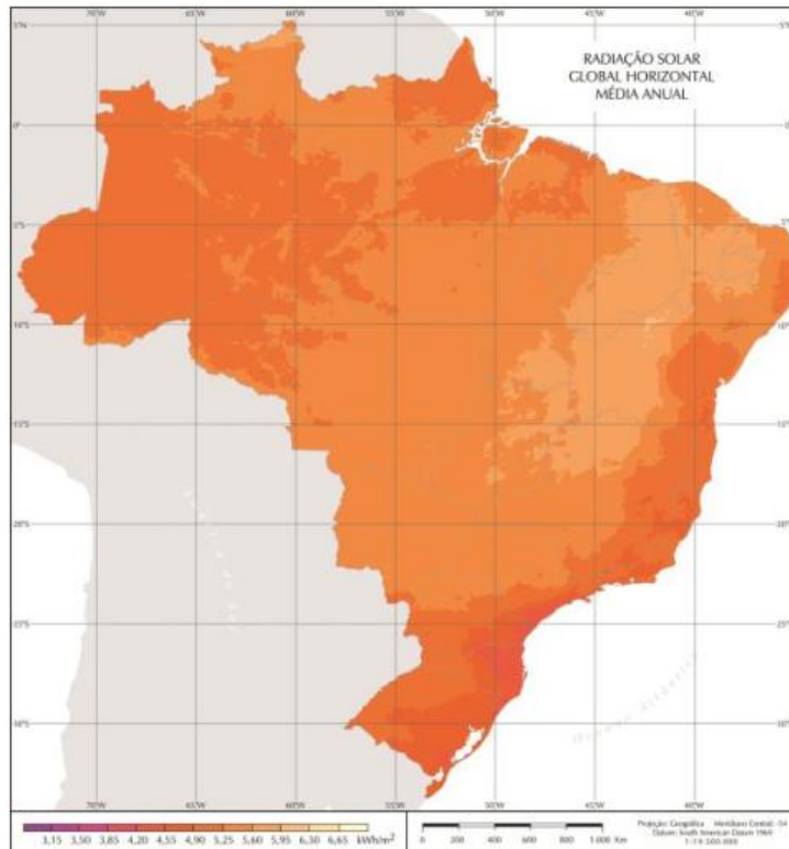
Figura 2- Média anual da radiação solar global do Brasil. Pode-se observar que o valor máximo de irradiação, 6,5 KWh/m 2 , ocorre no Norte do estado da Bahia.
