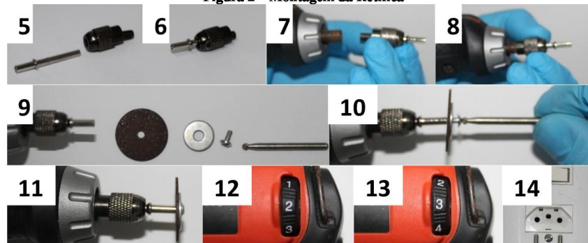
Figura 2 – Montagem da Retífica
