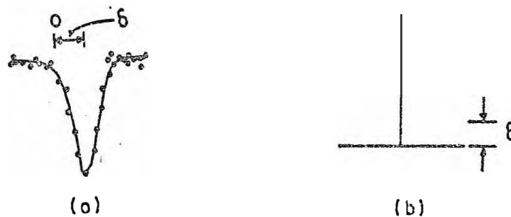
Figura 3.4 (a) Espectro Mössbauer mostrando o deslocamento do nível de ressonância (b) Esquema do nível de energia no núcleo absorvedor do ferro ressonante correspondente ao espectro em (a).
