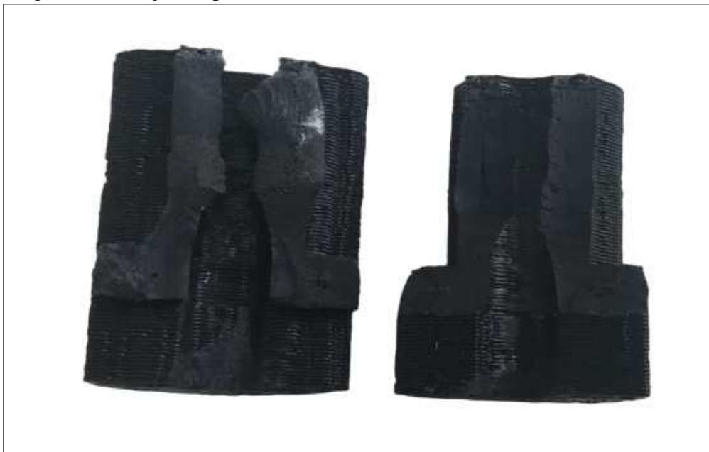
Figura 15 – Peça rompida feita com PLA
