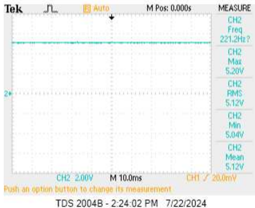
Figura 27 – Tensão de alimentação ( V_{cc} ) do sensor de efeito Hall
