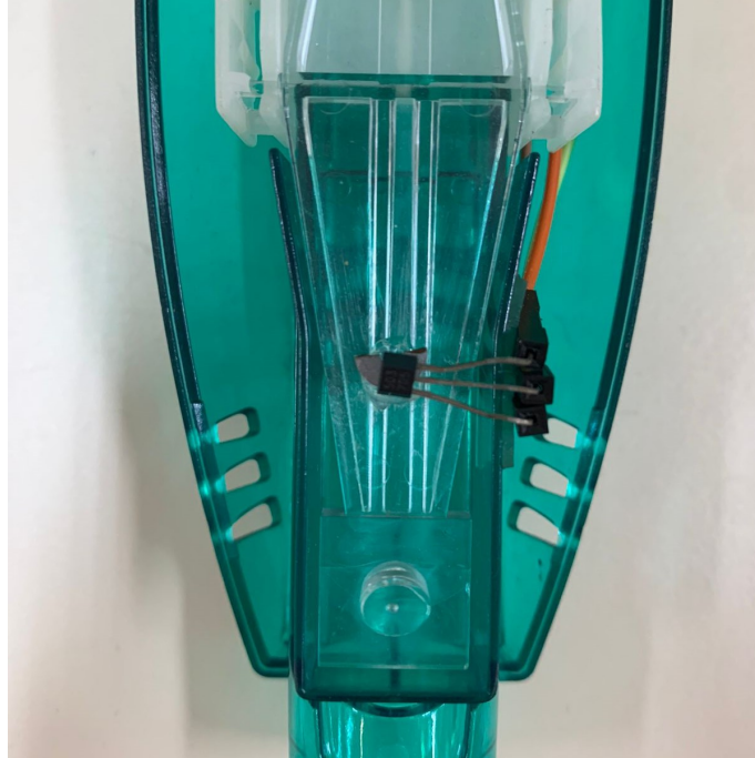
Figura 23 – Configuração de montagem do ímã e do sensor de efeito Hall
