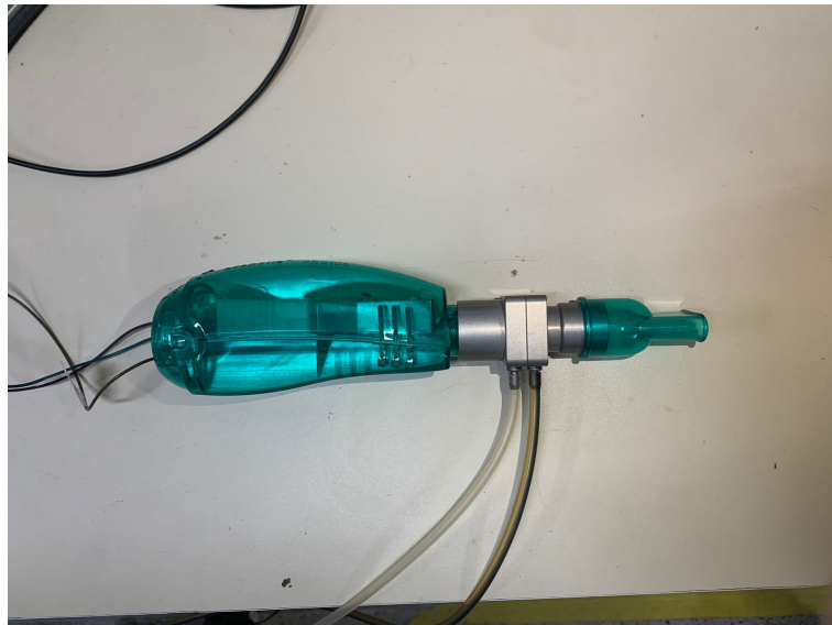
Figura 31 – Acoplamento do pneumotacômetro ao dispositivo Acapella Choice
