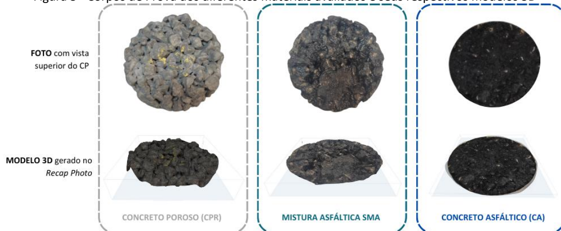
Figura 5 - Corpos de Prova dos diferentes materiais avaliados e seus respectivos modelos 3D
