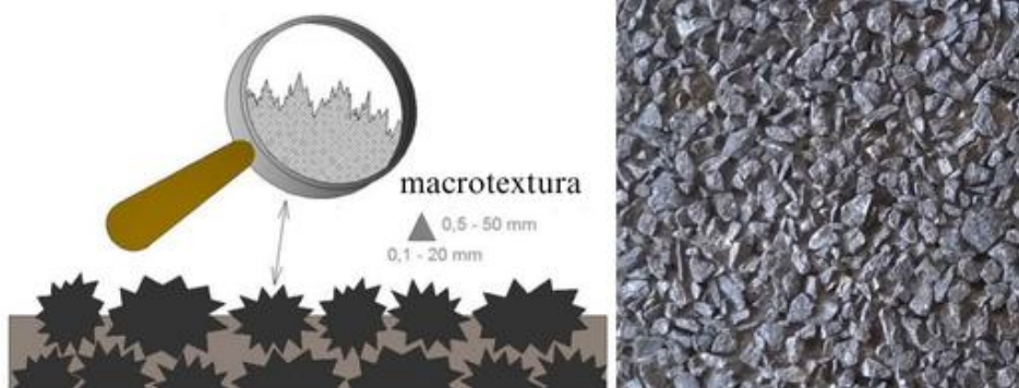
Figura 1 - Esquema da macrotextura de superfície asfáltica
