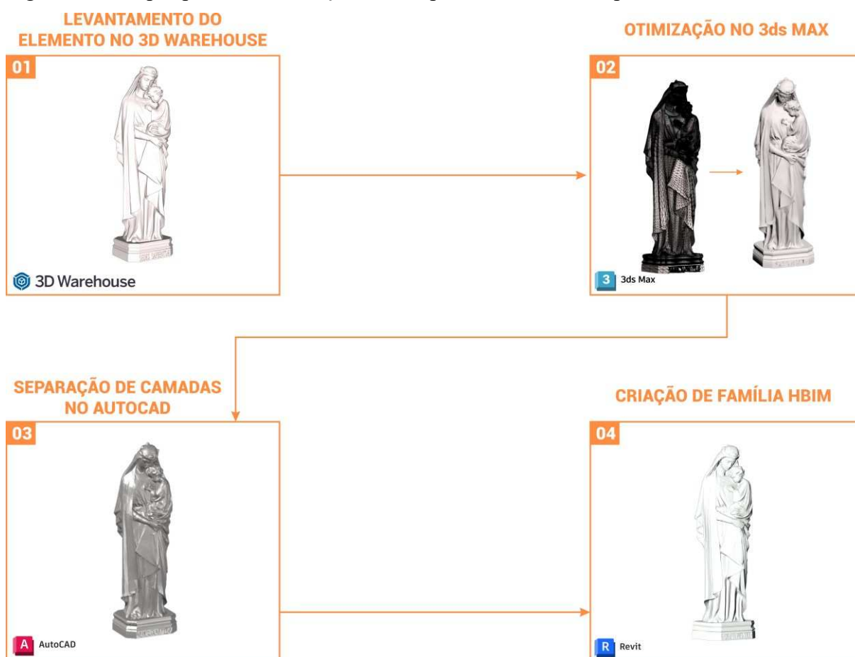
Figura 33 – Etapas para transformação do componente do SketchUp® em família HBIM
