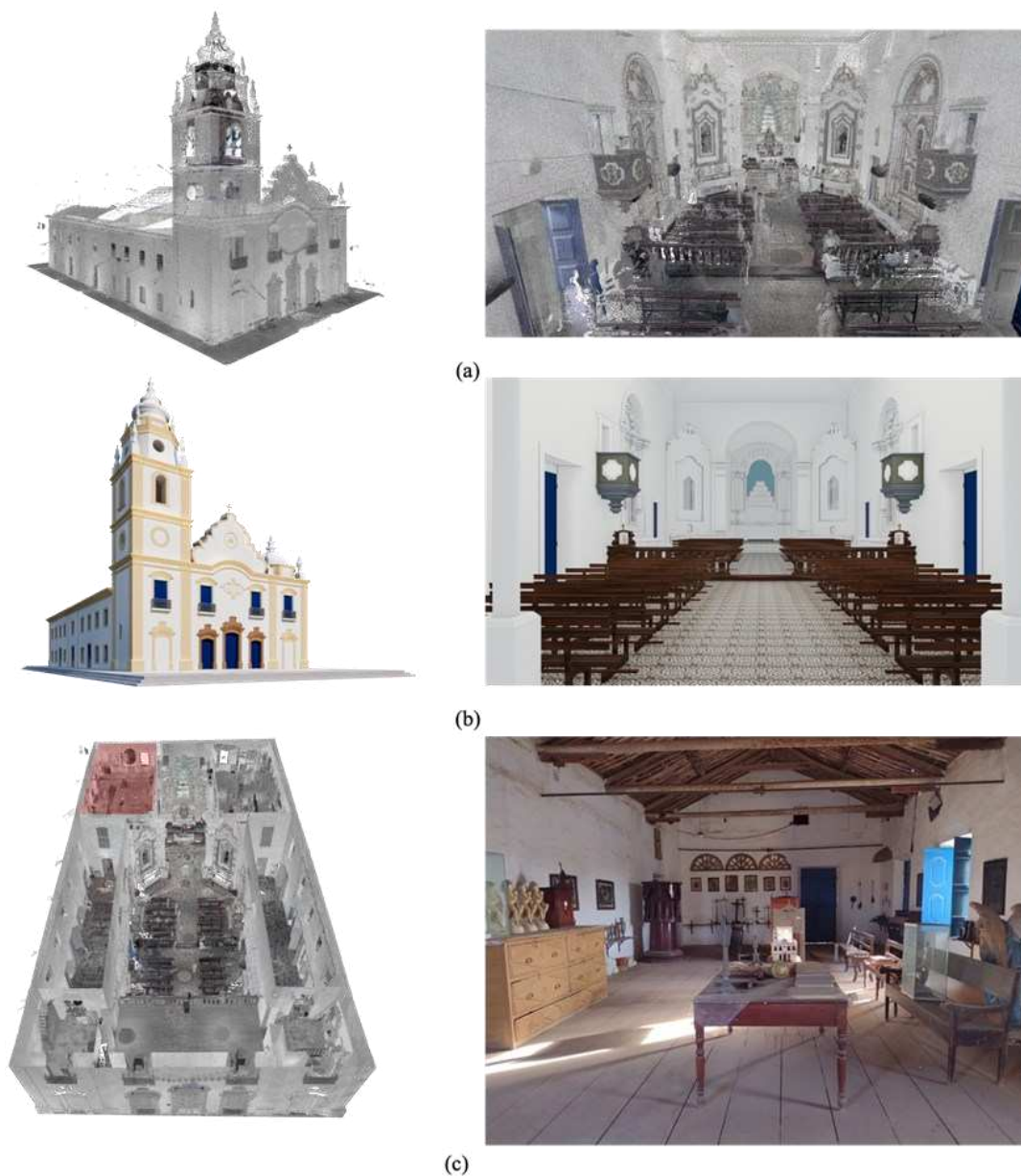
Figura 28 - Documentação existente: (a) nuvem de pontos, (b) modelo HBIM e (c) nuvem de pontos e foto da sala com o acervo
