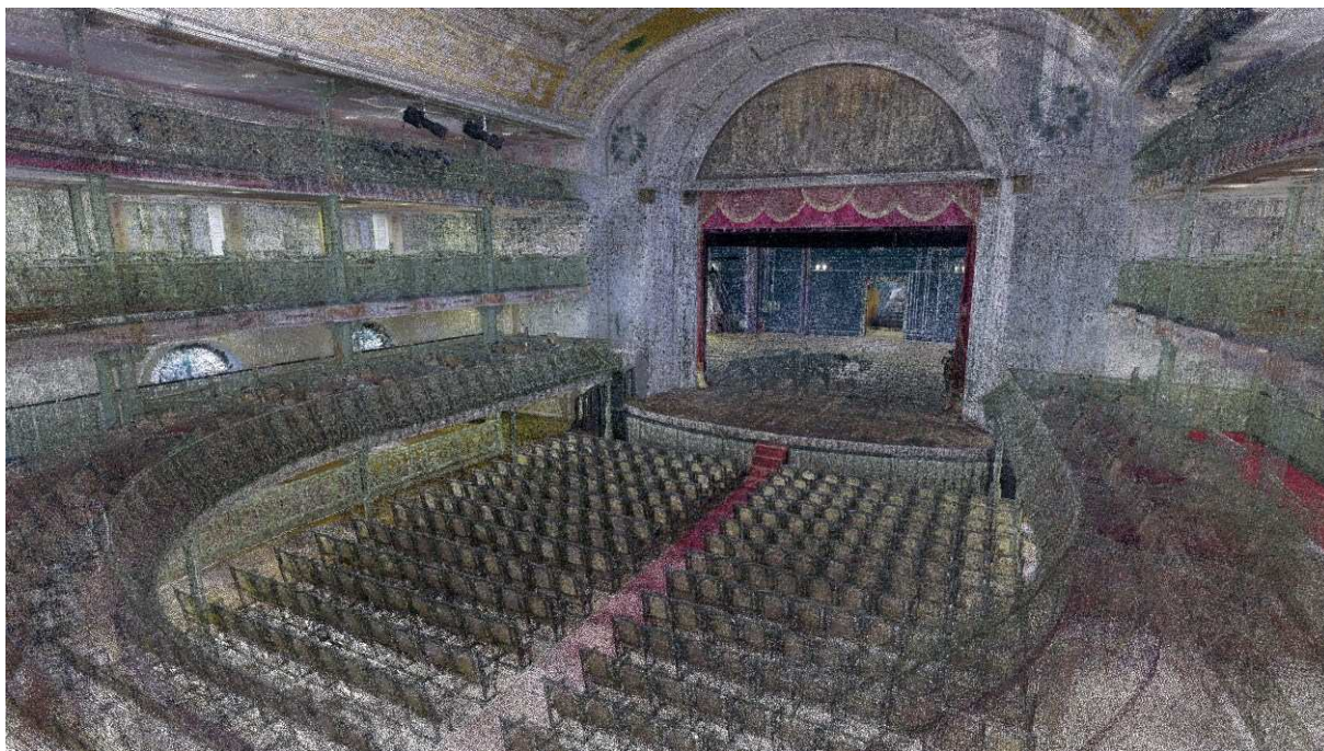
Figura 4 - Exemplo de nuvem de pontos 3D gerada por laser scanner
