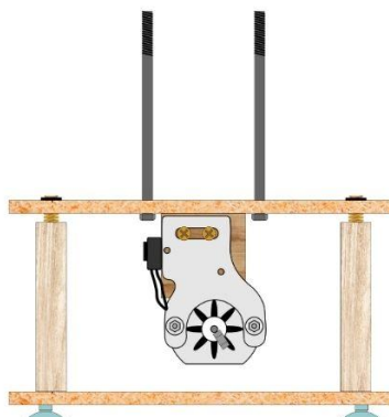
Figura 26 - Passagem dos parafusos sextavados no círculo de MDF A .
