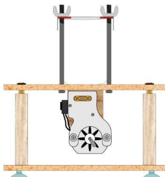
Figura 27 - Posicionamento e fixação do bequer sobre a plataforma vibratória.
