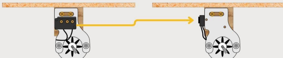
Figura 22 - Fixação lateral da tomada do motor.
