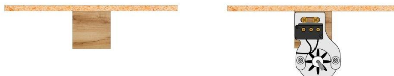
Figura 21 - Fixação do motor na ripa de pinus
