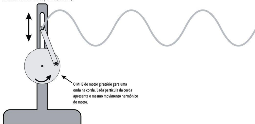
Figura 2.4 - Geração de uma onda transversal em uma corda por um motor em movimento harmônico simples (MHS).
