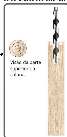
Figura 10 - Perfuração para os parafusos das colunas.
