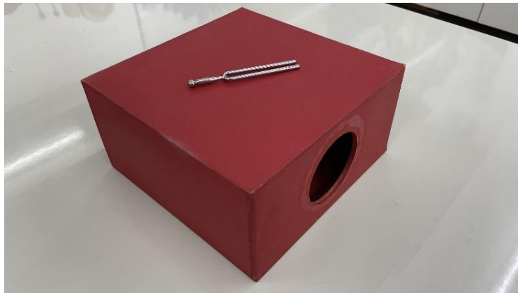
Figura 13 – Experimento do diapasão com a caixa de ressonância.
