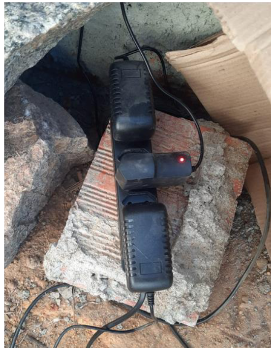
Figura 14: Instrumentação: transmissor (a); fontes conectadas à extensão (b)
