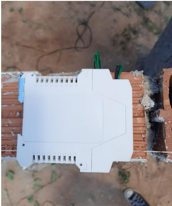
Figura 14: Instrumentação: transmissor (a); fontes conectadas à extensão (b)
