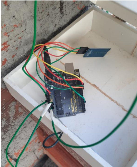
Figura 13: Instrumentação: arduino (a); módulo micro SD (b)
