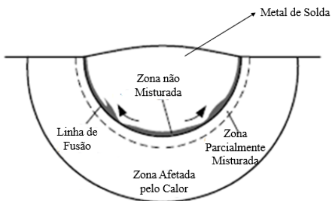
Figura 5 – Ilustração esquemática das regiões de soldagem dissimilar.
