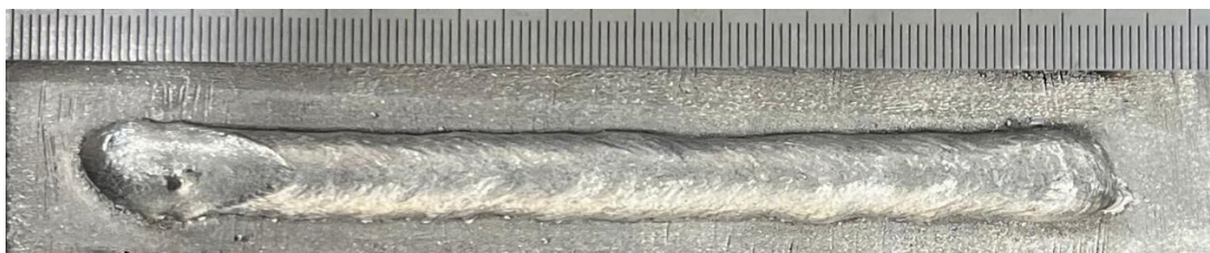
Figura 46 – Cordão isolado da melhor condição com o curto-circuito operando como arame seguidor
