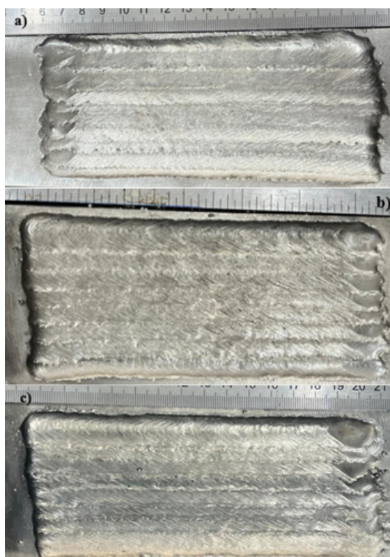
Figura 73 – Soldagens de revestimentos de uma camada para as três ligas a) 50%H/50%I b) 70%H/30%I c) 30%H/70%I
