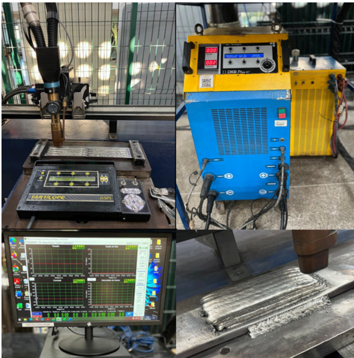
Figura 21 – Equipamentos usados para realização das soldagens
