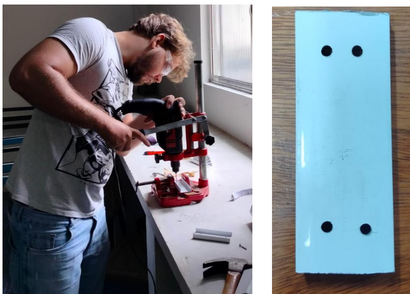
Figura 20 – Furações dos perfis de alumínio
