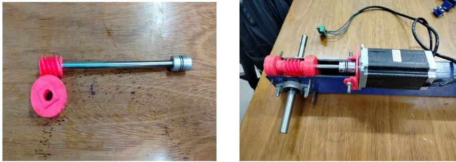
Figura 16 – Eixo do motor com acoplamento e engrenagem sem fim. (À esquerda), eixo montado ao sistema sob guias e limitadores (À direita).
