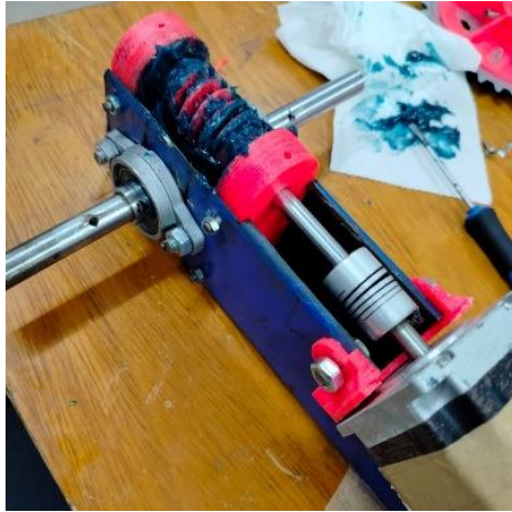
Figura 18 – Sistema de transmissão lubrificado com graxa
