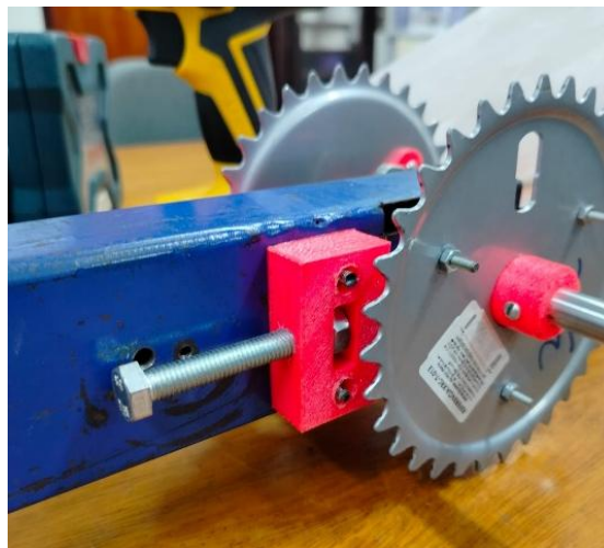
Figura 22 – Montagem dos tensionadores.
