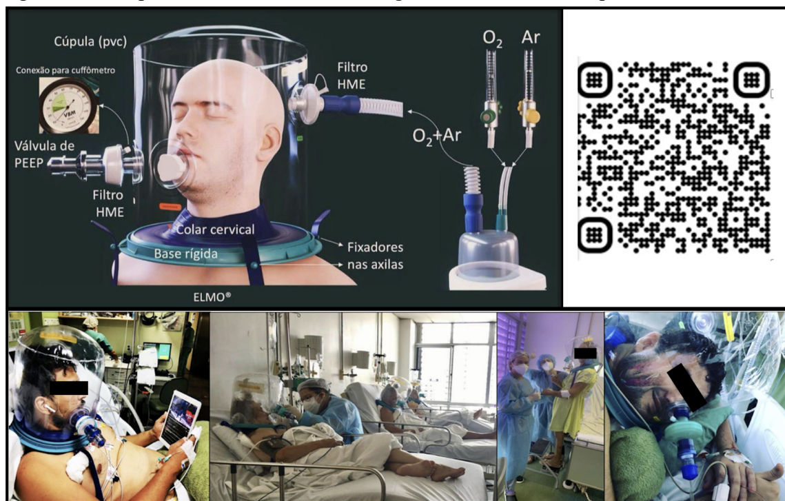
Figura 2 – Componentes do ELMO-CPAP e pacientes em uso do capacete ELMO®.
