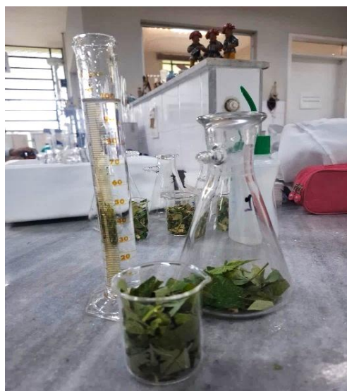
Figura 2- A amostra pesada e transferida para o interior de um kitassato
